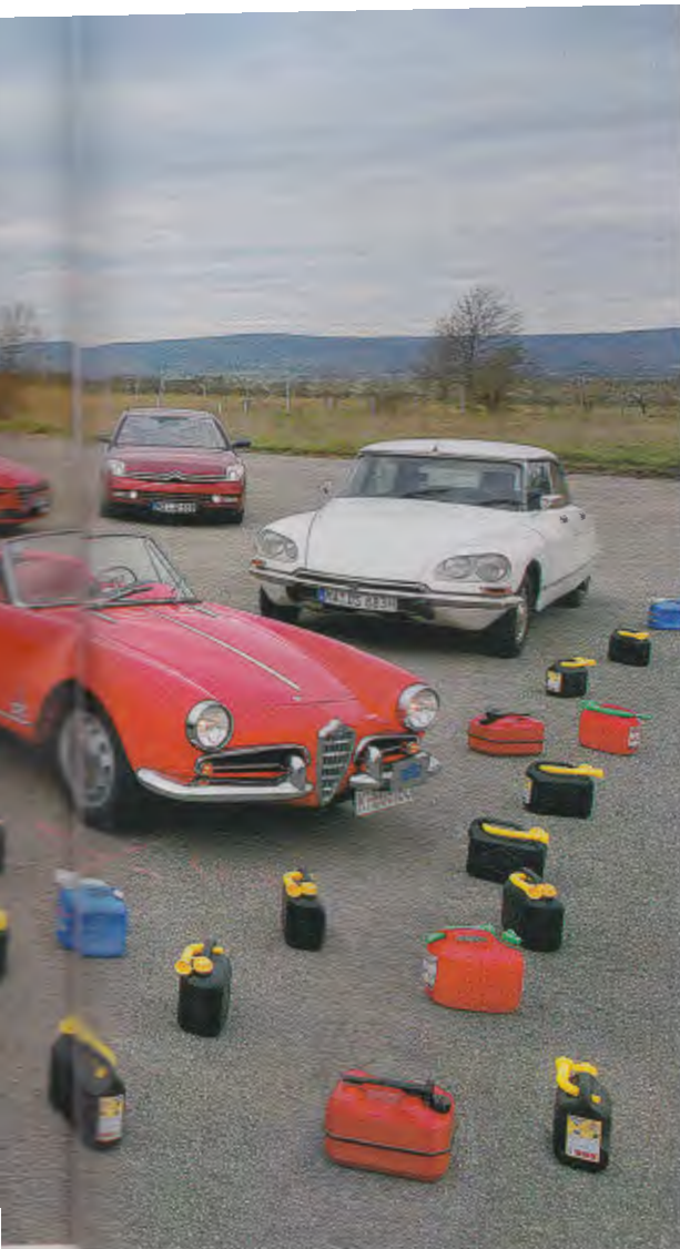
Es ist vor allem das höhere Gewicht der Neuwagen, das die Fortschritte im Motorenbau zunichte macht. Der Alfa Romeo Giulietta Spider wiegt 860 Kilo, sein Enkel bringt 1608 Kilo auf die Waage. In unserem Test verbrauchte der Oldtimer 6,9 Liter, der Neuwagen 11,2
